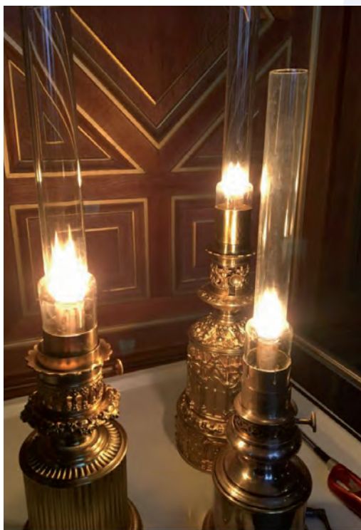
En 2017, essais d'éclairage avec lampe à huile mécanique dans la galerie des Assiettes. Remise des globes de verre après stabilisation de la mèche. Contrôle avec lampe carcel électrifiée servant de référence pour l'appréciation de la température des couleurs. ©Arnaud Amelot
